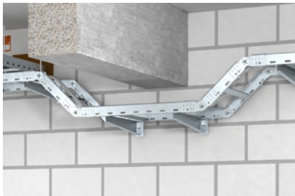
AW 30 Seinäkannake asennetaan seinään sopivilla ankureilla. Tikashylly kiinnitetään kannakkeeseen LKS 40 kiinnityskappaleella.
